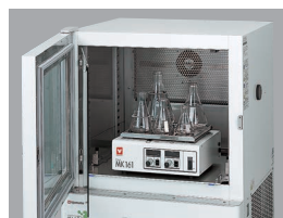
Ejemplo de uso de la base para montaje y soportes para matraces erlenmeyer (opcional)
