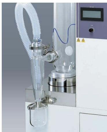
El sistema de extracción de un solo toque simplifica la extracción y la limpieza de la cámara de secado, del ciclón y del recipiente del producto.
