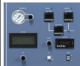
La temperatura de entrada, la temperatura de salida y la cantidad de aire de secado se indican digitalmente. Un panel táctil permite realizar ajustes, muestra el estado de las operaciones y los errores, y los ajustes de varias condiciones de operación.
