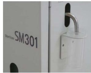
Colector de Condensación
